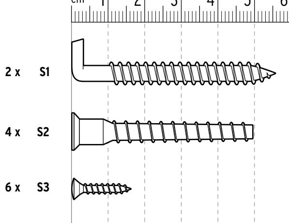
Für den Zusammenbau benötigen Sie | Pour le montage, il vous faut | Per il montaggio sono necessari | Assembly will require
